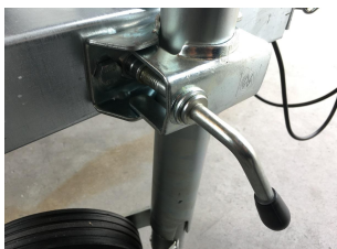
Roue jockey avec collier démontable / modèle non freinée
