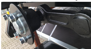
Essieu non freiné 750 kg : Moyeu surdimensionné et bras en acier forgé
