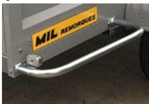
Protections latérales avec support signalisation
