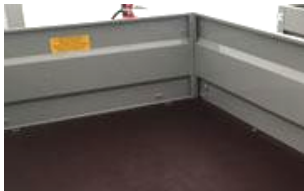
Plancher multicouche traité Marin avec croches d'accroches
